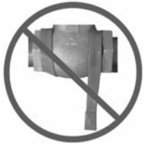
B.) Falsche Montage: Heizband hängt lose von der Oberfläche
