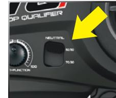
**50/50:** Ermöglicht gleiche Hebelbewegung für vorwärts und rückwärts
