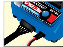
Des Weiteren verfügt der VXL-3s über eine Sensorphasen-Erkennung. Wenn ein bürstenloser Motor mit Sensoren angeschlossen ist, überprüft der VXL-3s, ob er richtig verkabelt ist. Falls die Motorphasen-Verkabelung nicht richtig ist, gibt der VXL-3s keine Energie an den Motor ab, bis dieser richtig verkabelt ist.
