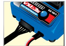
Le VXL-3s est également prévu d'un détecteur de phase du capteur. Lorsqu'un moteur sans balais à capteur est branché, le VXL-3s vérifie que le câblage est adéquat. Si le câblage de phase du moteur est incorrect, le VXL-3s n'alimente pas le moteur en énergie jusqu'à ce qu'il soit câblé correctement.
