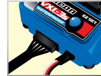
Le VXL-3s est également prévu d'un détecteur de phase du capteur. Lorsqu'un moteur sans balais à capteur est branché, le VXL-3s vérifie que le câblage est adéquat. Si le câblage de phase du moteur est incorrect, le VXL-3s n'alimente pas le moteur en énergie jusqu'à ce qu'il soit câblé correctement.
