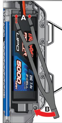
Instale las baterías de modo que los cables de la batería estén orientados hacia la parte trasera del modelo. Inserte las lengüetas de la sujeción de la batería pueden las ranuras de la retención del botón de bloqueo trasero (A). Incline el botón de la batería hacia el chasis y presione (bloquear) el extremo en la retención del botón de bloqueo delantero (B).
