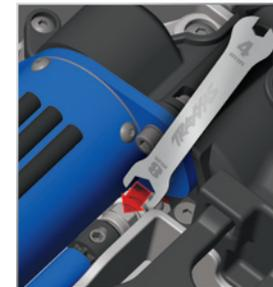
Coloque el modelo en una superficie de alta tracción, como una alfombra. Regule el embrague antirrebote de forma tal que pueda oírlo deslizarse por aproximadamente dos pies desde la posición de detenido a toda aceleración. (Conozca más acerca del ajuste del embrague antirrebote en la columna lateral).
