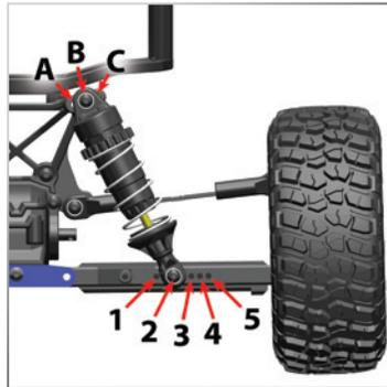
La suspensión de su modelo se ha configurado para un rendimiento todoterreno (posición 2 en los brazos de suspensión delanteros y posición 3 en los brazos de suspensión traseros). Si tiene planeado conducir en superficies duras, deberá realizar los siguientes cambios:
