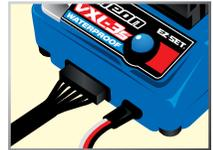
El VXL-3s también cuenta con detección de fase de sensor. Cuando un motor sin escobillas y con sensores está conectado, el VXL-3s verifica que el cableado sea adecuado. Si el cableado de la fase del motor es incorrecto, el VXL-3s no aplicará corriente al motor hasta que el cableado sea correcto.
