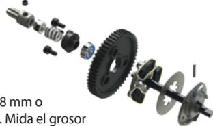
• **Sistema de transmisión:** Inspeccione el sistema de transmisión en busca de señales de desgaste, como horquillas desgastadas, semiejes sucios y cualquier ruido o pieza doblada que no sea normal. Si una junta en U se rompe, es hora de reemplazar la pieza. Extraiga la cubierta de engranajes. Inspeccione el engranaje cilíndrico para ver su desgaste y controle el ajuste de los tornillos de presión en los engranajes de piñón. Ajuste, limpie o reemplace los componentes según sea necesario.
