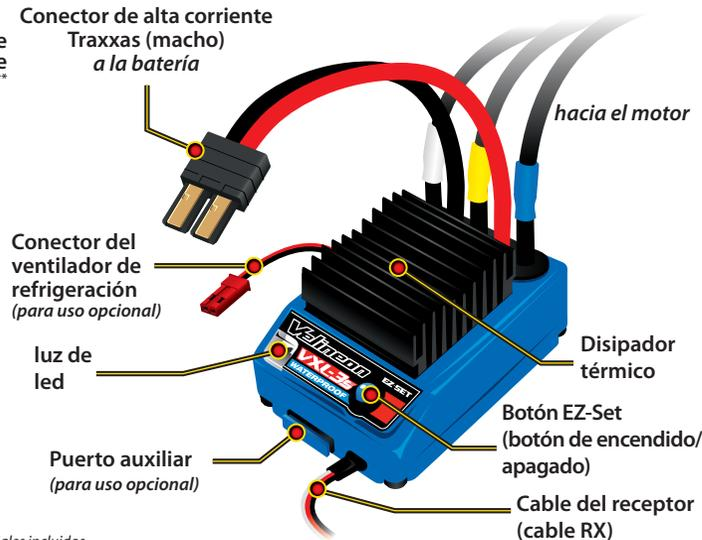
*Diagrama de cableado del motor/ESC*
