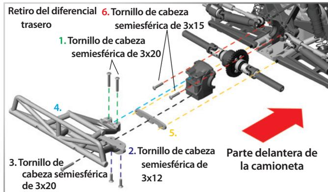
2. Voltee el chasis y retire los dos tornillos avellanados de 3x12 mm que sostienen el paragolpes/placa de deslizamiento al mamparo. Los dos tornillos delanteros no se deben retirar.
