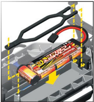
Instale las baterías de modo que los cables de la batería estén orientados hacia la parte trasera del modelo. Inserte las lengüetas de la sujeción de la batería en las ranuras del retén de la sujeción trasera y luego coloque la sujeción de la batería sobre el borne. Fije la sujeción de la batería con un gancho de carrocería en el orificio que se encuentra en el borne. Todavía no conecte el paquete de baterías.
