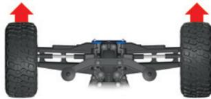
7. Maneje con suavidad el gatillo de velocidad para asegurarse de tener marcha adelante y marcha atrás y de que el motor se detiene cuando el gatillo de velocidad está en posición neutral. **ADVERTENCIA: No aplique aceleración total en marcha adelante o atrás mientras el modelo se encuentre elevado.**
