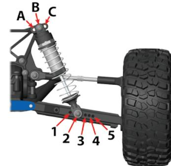
La suspensión de su modelo se ha configurado para un rendimiento todoterreno (posición 2 en los brazos de suspensión delanteros y posición 3 en los brazos de suspensión traseros). Si tiene planeado conducir en superficies duras, deberá realizar los siguientes cambios:
