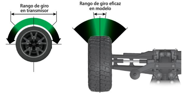
¡Experimente! Pruebe distintos grados de exponencial. Es fácil volver a "cero" si no le gusta el efecto. No hay una forma incorrecta de regular el exponencial. Cualquier configuración con la que se sienta cómodo para manejar su modelo es la "configuración correcta".
