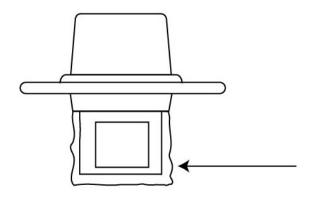
BLACK FOAM FILTER BAG (THE ONLY FILTER USED FOR WET PICK-UP)
