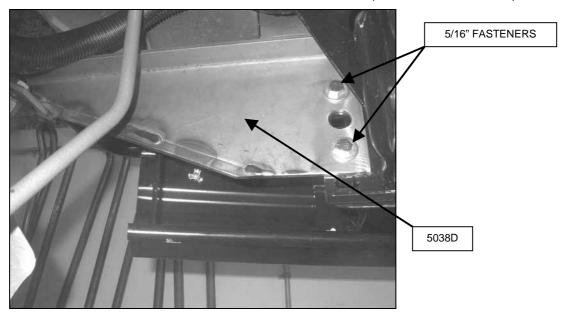
**STEP 4.** INSERT THE DRIVER SIDE BRUSH GUARD MOUNTING TAB THROUGH THE CUT OUT IN THE BUMPER FASCIA AND POSITION IT ON THE BOTTOM OF THE MOUNTING BRACKET TAB.
