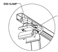
END STOP QUANTIES REQUIRED: -2 PER CONTROL SIDE OF FESTOON SYSTEM (1 EACH END) -1 PER POWER SIDE OF FESTOON SYSTEM
