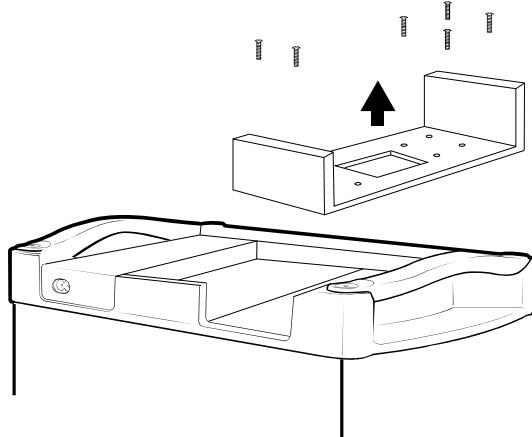
2. Relevez le couvercle du Yeti Lithium et extrayez le support du module d'expansion du Yeti endévissez les six vis et en le faisant glisser vers le haut.
