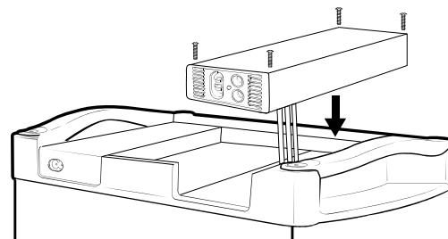
5. Coloque suavemente el módulo de optimización de carga solar en su posición, plegando los cables hacia la apertura.
