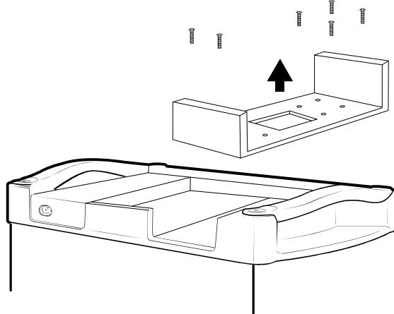
2. Abra la tapa del Yeti Lithium y extraiga el carro del módulo de expansión del Yeti retirando los seis tornillos y deslizándolo hacia afuera el carro.
