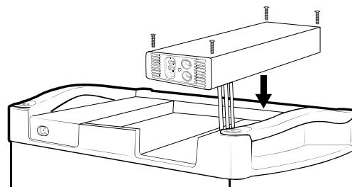
5. Placez avec précaution le module d'optimisation de charge solaire, en repliant les câbles dans l'ouverture.
